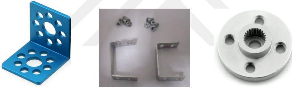
Şekil 3.2 Altu Robotu Oluşturan Tutucu Parçalar, DC Motor Tutucu Parçası(solda) Servo Motor Kenar Tutucuları (ortada), Vidaları ve Somunları (ortada) Servo Motor Dönen Tutucu Parçası (sağda)
