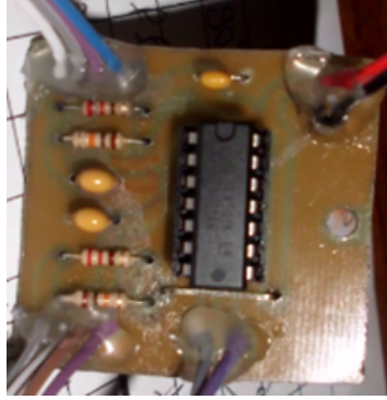
Şekil 3.23 74HC14 ile Tasarlanmış Devrenin Görüntüsü
