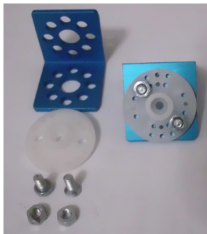
Şekil 3.3 Altu Robotun DC ve Servo Motorlarının Tutucularının Birleştirilmesi
