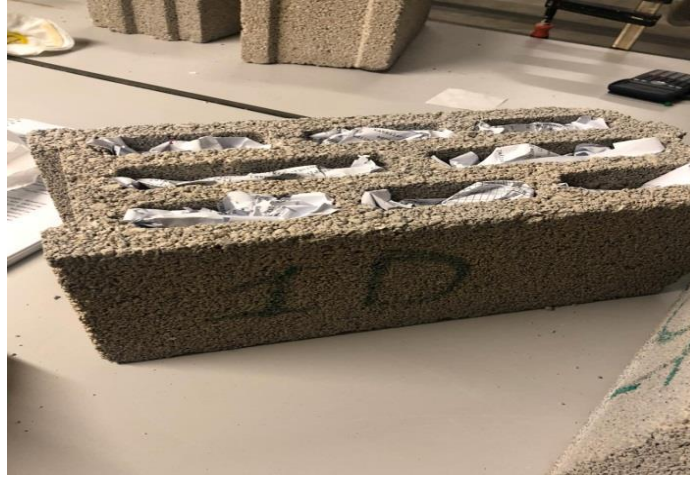
Şekil 24. Bimsblok boşluklarının doldurulması
