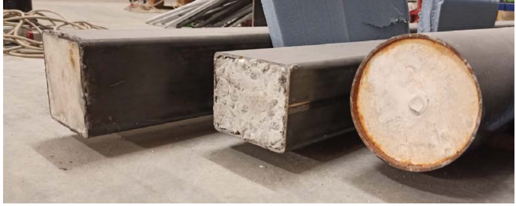
Şekil 9. BDKE kiriş numuneleri (a) Numunelerin diklik kontrolü, (b) 28 gün boyunca dik konumda tutulması, (c) 3 farklı kesitteki BDKE kirişler
