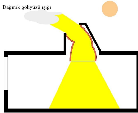
Şekil 17. Anidolik tavan sistemi şematik gösterimi
