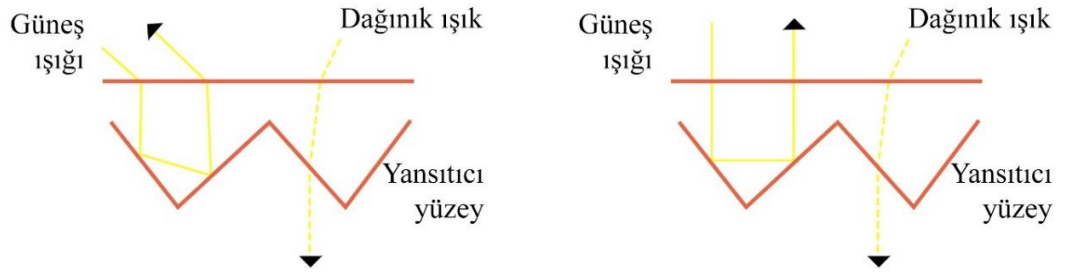
Şekil 8. Güneş ışığı açılarına göre prizmatik panellerin çalışma prensibi
