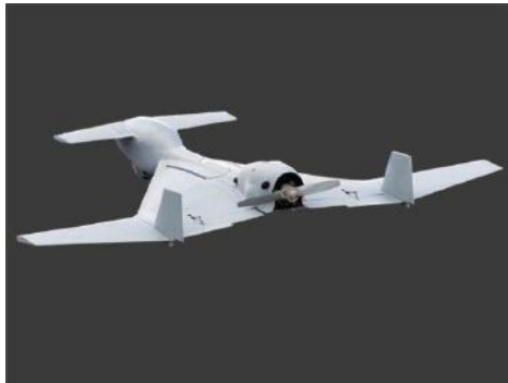
Şəkil 13: İsrail "kamikadze"-si adını almış "Harop" tipli (a və b) ZPUA
