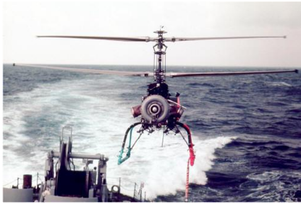
Şək. 1. ABŞ Hərbi Dəniz Qüvvələrinin sifarişi ilə qayıq əleyhinə hazırlanmış məsafədən idarəolunan eynioxlu sxem əsaslı “QH-50 DASH” helikopteri.
