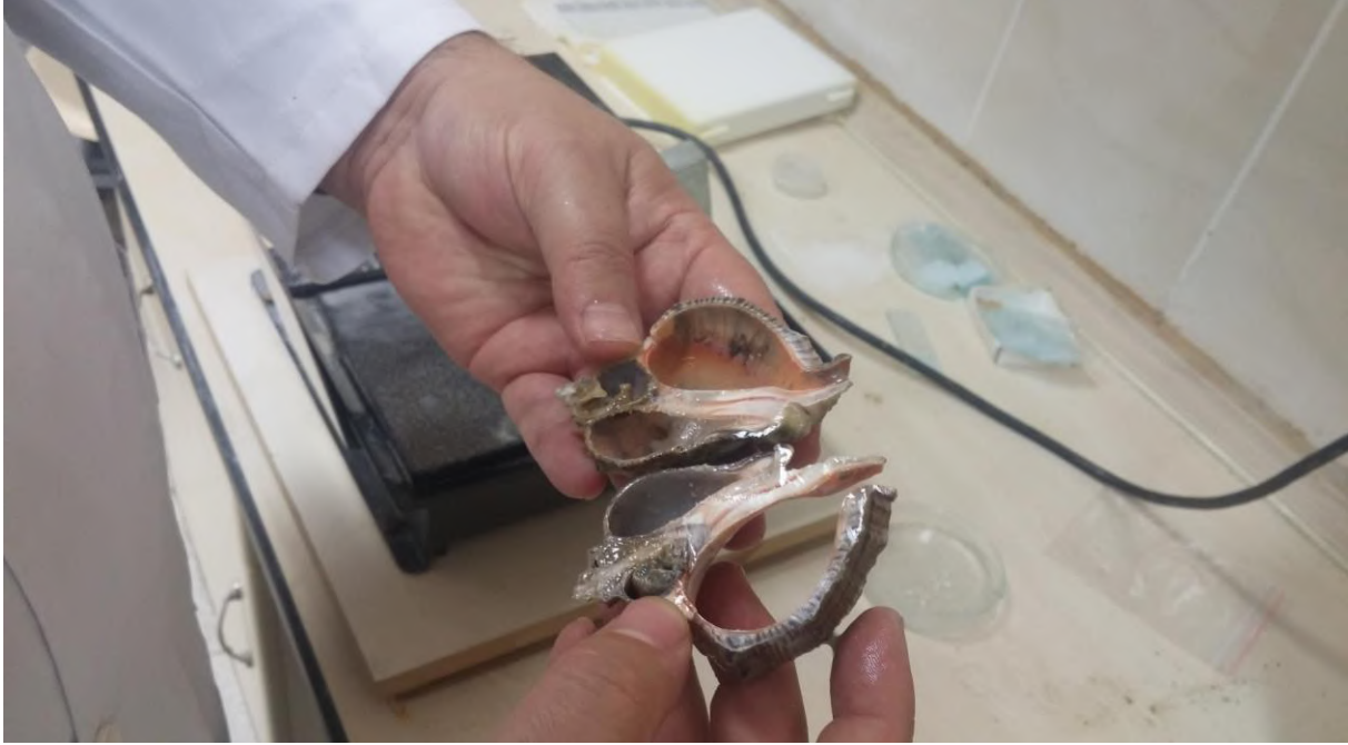
Şekil 2. Deniz salyangozu kabuğunun Ray Tech marka keski makinası ile dikey kesimi
