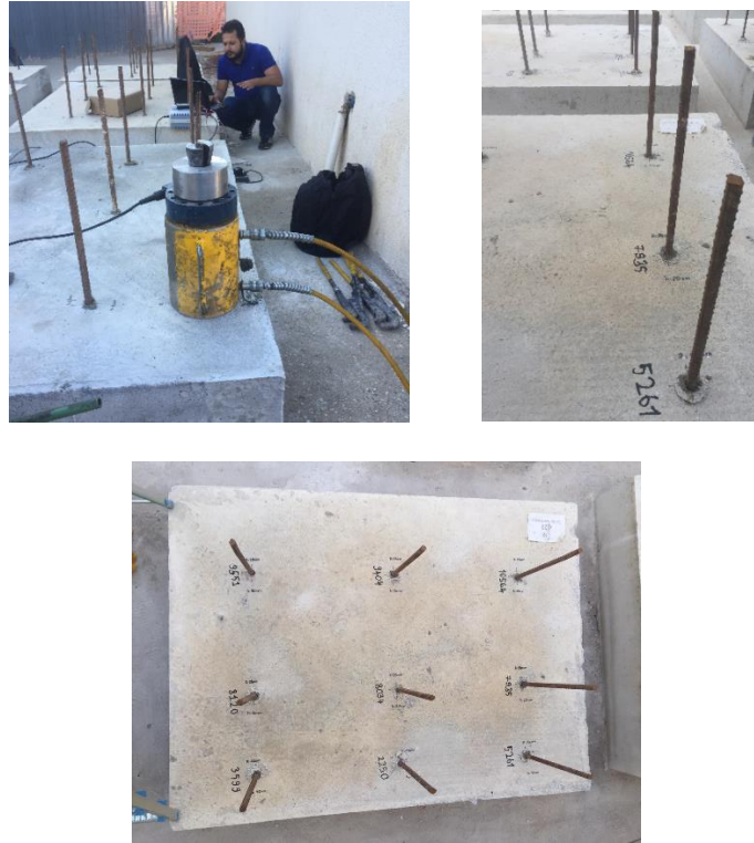
Şekil 9. Çekip Çıkarma Deneyleri
