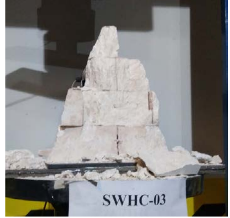
d) SWHC-03 numunesinin nihai yükten sonraki kırılma şekli
