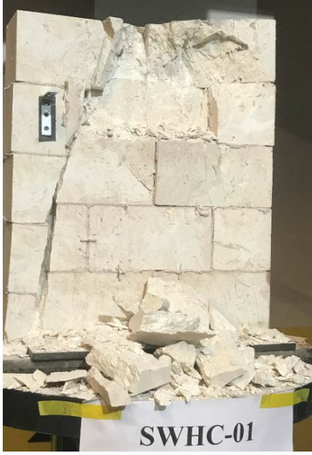
a) SWHC-01 numunesinin nihai yükten sonraki kırılma şekli
