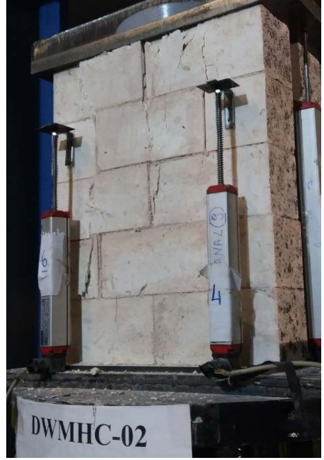
b) DWMHC-02 numunesinin nihai yükten sonraki kırılma şekli
