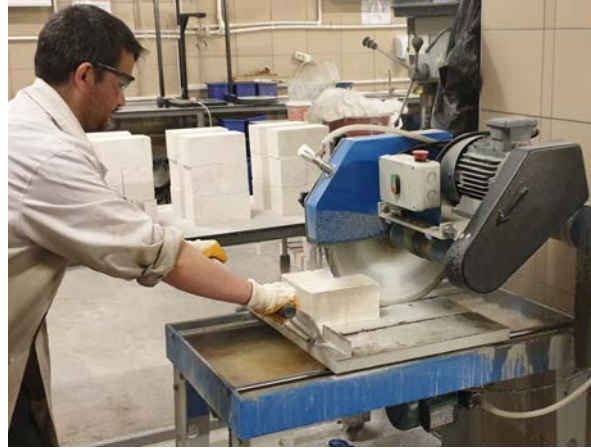
Şekil 22. Taşların kesilmesi ve basınç deneyi için hazırlanması
