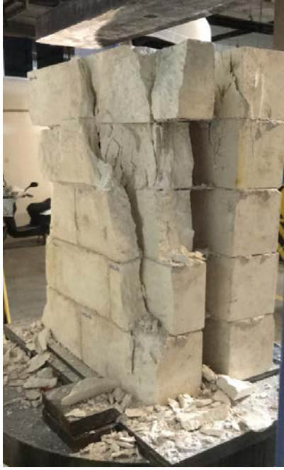
a) DWMHC-01 numunesinin nihai yükten sonraki kırılma şekli
