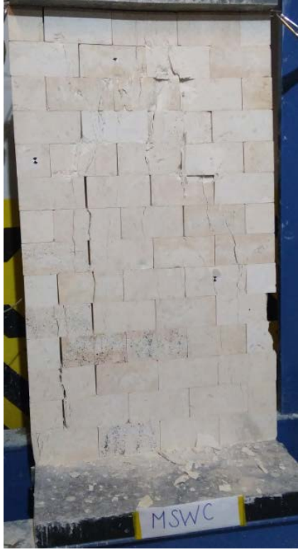
a) MSWC numunesine ait kırılma şekli
