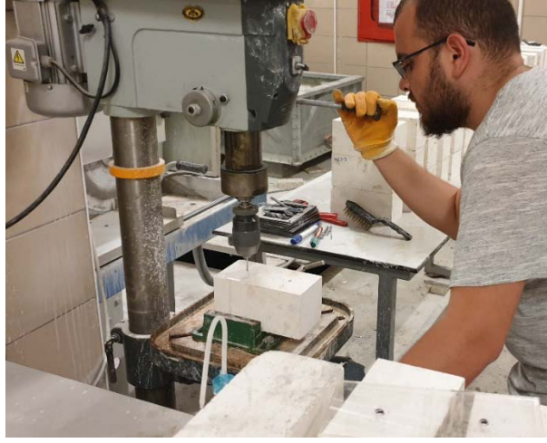
Şekil 28. Taşlarda zıvana deliklerin açılması
