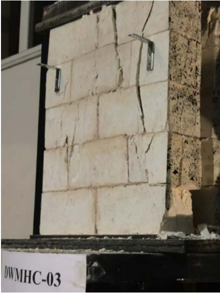
c) DWMHC-03 numunesinin nihai yükten sonraki kırılma şekli
