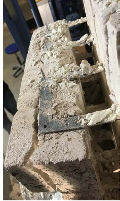
d) Numunelerde kenetten dolayı kırılma şekli
