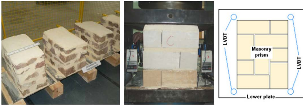
řekil 10. Standarda uygun olmayan deney numuneleri
