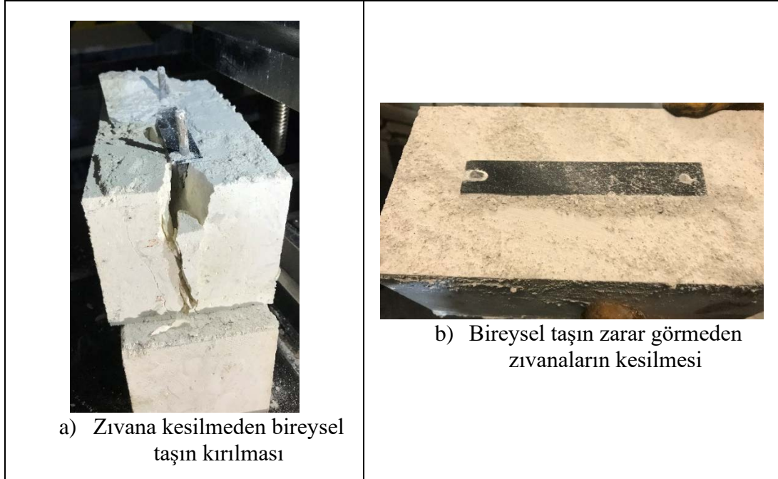
Şekil 57. Zıvana çapının yatay yüklere karşı davranışı
