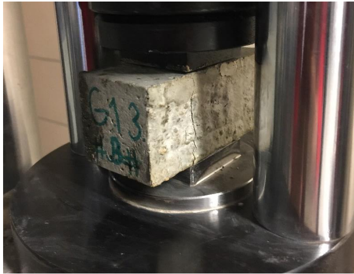
Şekil 44. Bims agregalı beton numunelerin basınç dayanımı sonrası kırılması
