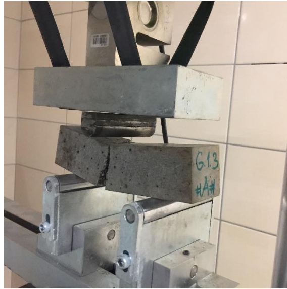
Şekil 42. Bims agregalı beton numunelerin eğilme dayanımı sonrası kırılması
