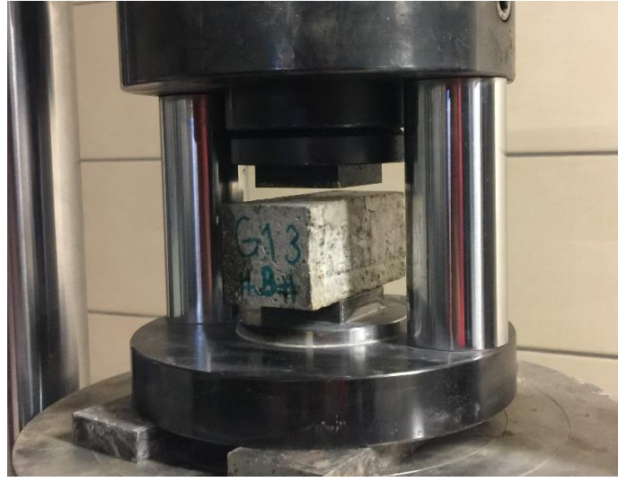
Şekil 43. Bims agregalı beton numunelerin basınç dayanımı cihazına yerleştirilmesi
