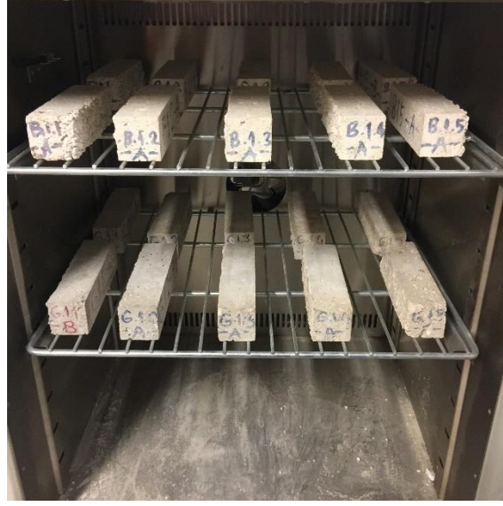
Şekil 46. Bims agregalı beton numunelerin don sonrası değişmez kütleyle kadar kurutulması
