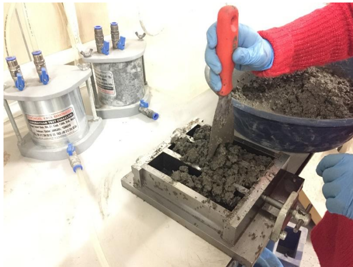
Şekil 49. Beton karışımının kalıplara dökülmesi
