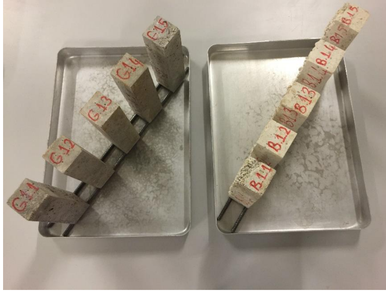
Şekil 39. Bims agregalı beton numunelerin kılcallık (kapilarite katsayısı) deneyi
