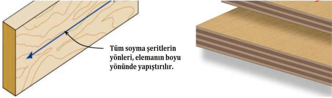
Şekil 7. LVL ile kontrplak arasındaki tabakalanma farkı
