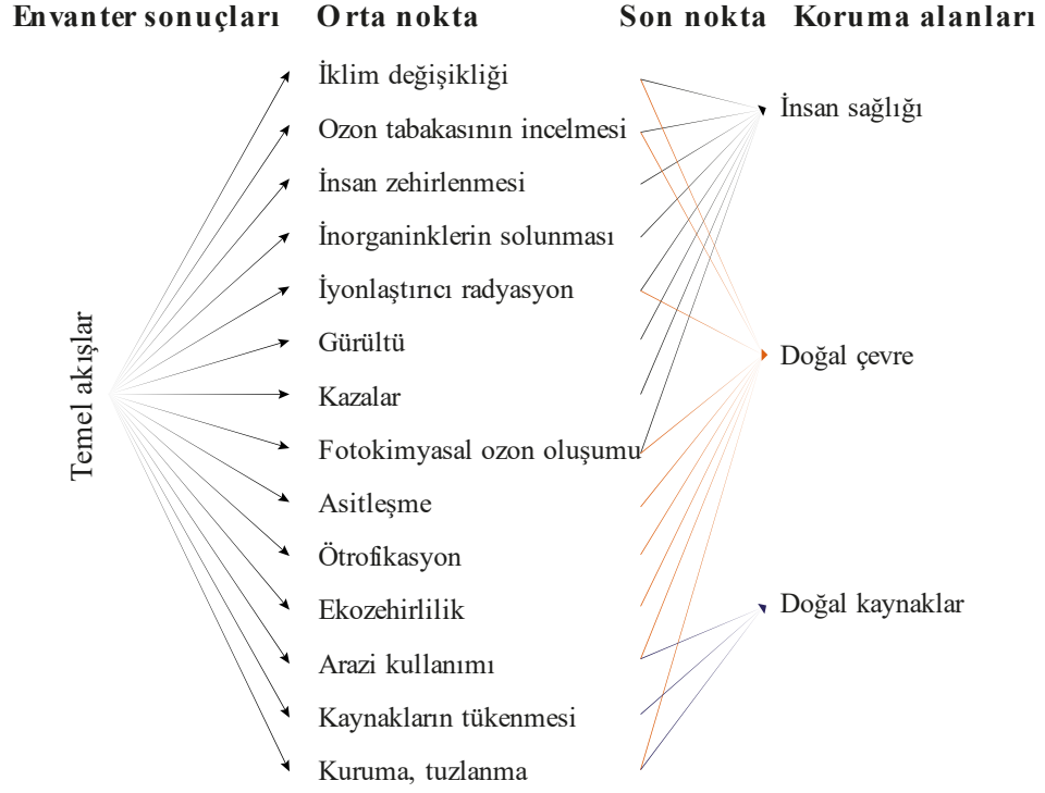
Şekil 22. Orta nokta ve son nokta (koruma alanı) seviyelerinde karakterizasyon modellemesi için etki kategorileri çerçevesi
