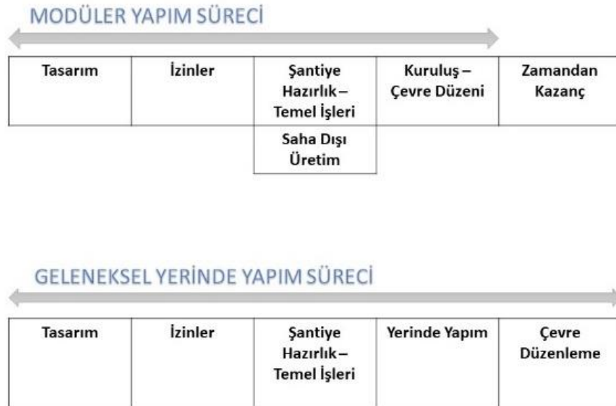
Şekil 12. Prefabrike ve geleneksel yapım süreçlerinin karşılaştırılması
