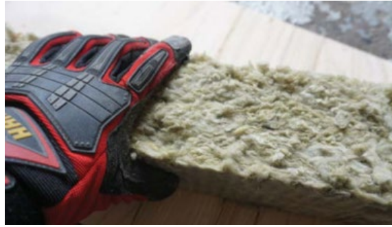
Şekil 41. Taş yünü yalıtım örneği
