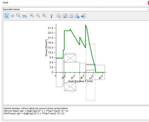
Şekil 5.61 Mil eşdeğer stres grafiği
