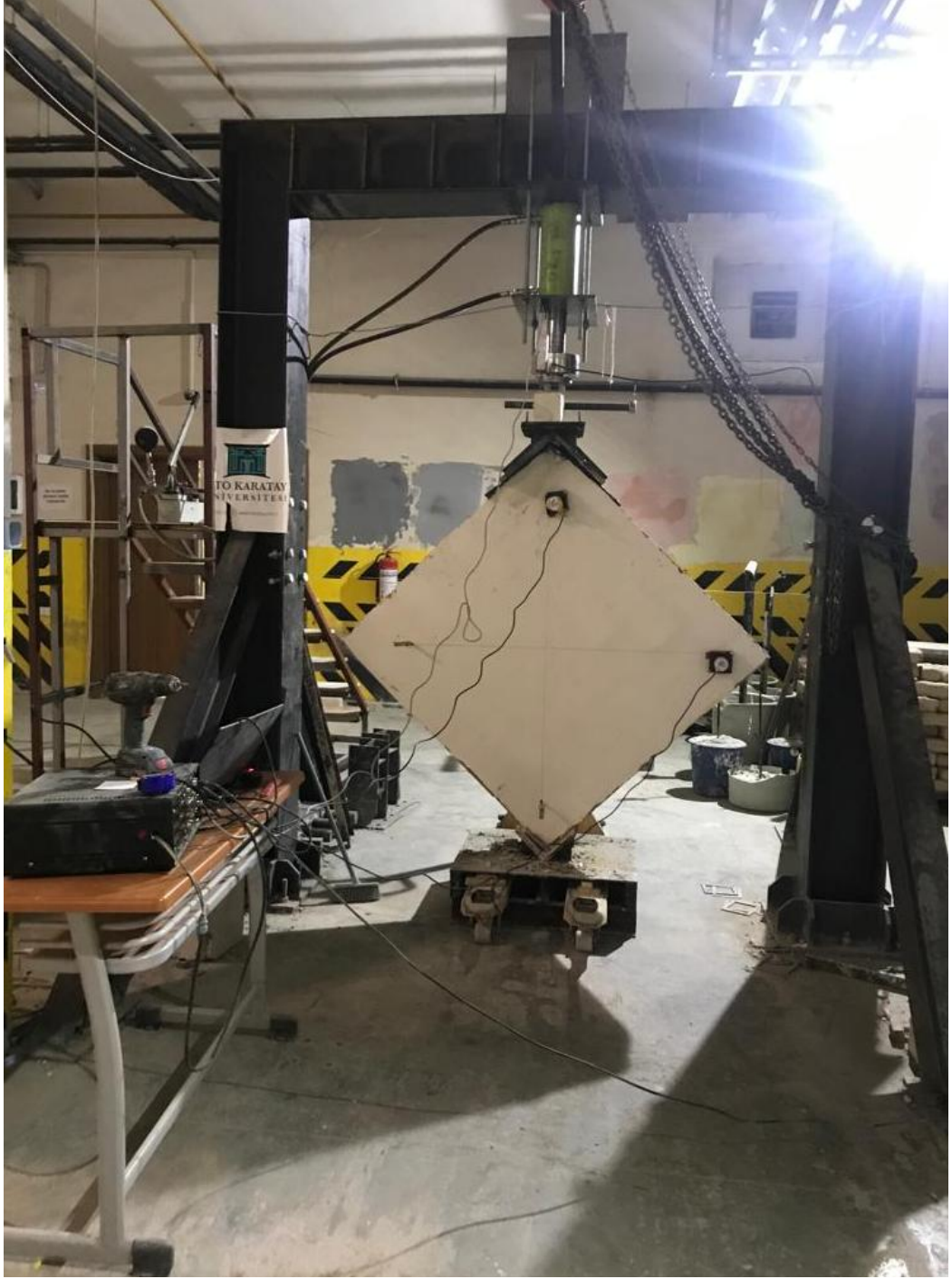
Şekil 24. V başlık altına yerleştirilmiş duvar deneyi
