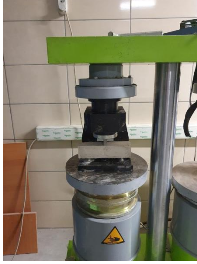
Şekil 9. Harç eğilmede çekme deneyi
