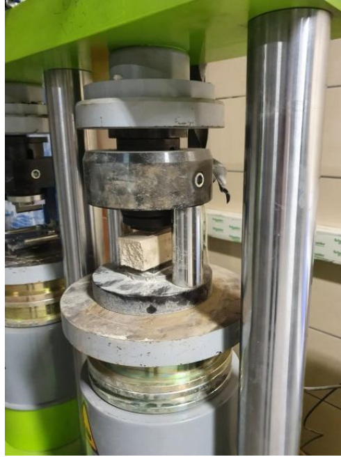
Şekil 8. Harç basınç deney düzeneği
