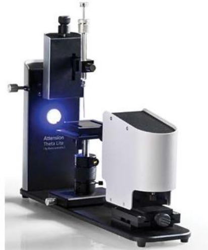
Şekil 59. Temas açısı analiz cihazı
