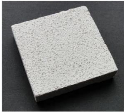
Şekil 36. Empa ve Fixit tarafından geliştirilen yüksek performanslı silika aerojel yalıtım sıva malzemesinin enine kesiti
