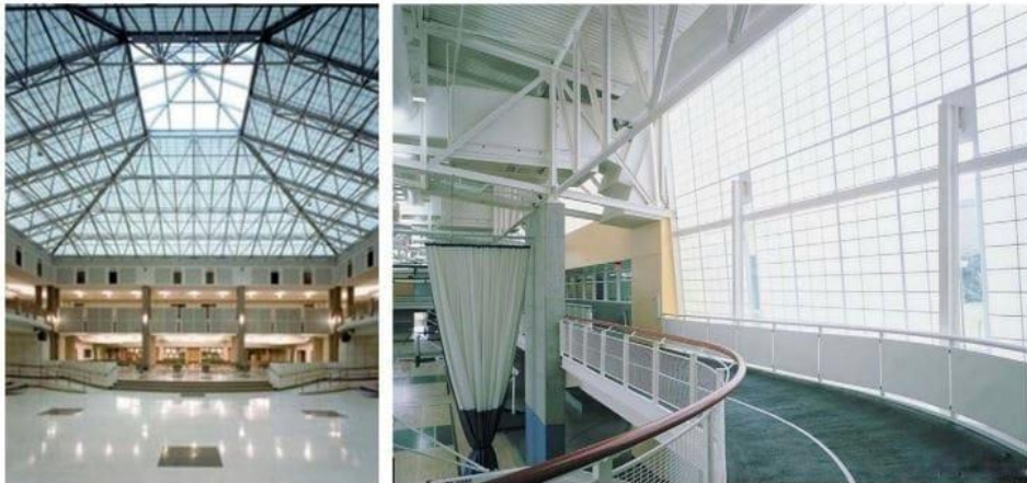
Şekil 33. Güneşli aydınlatması için yüksek performanslı bir ısı yalıtım çözümü olarak yarı saydam arojel yalıtımı örneği
