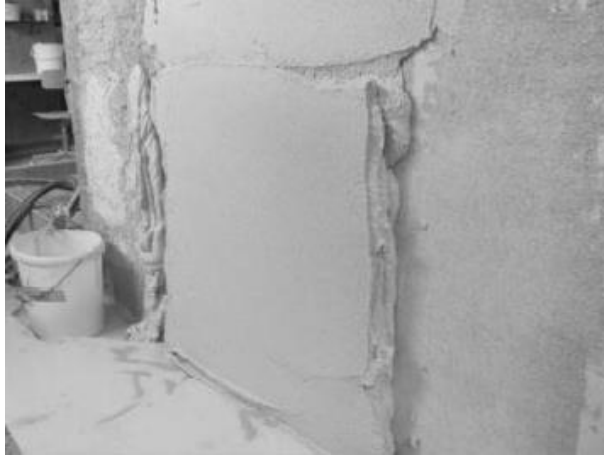
Şekil 35. Test duvarına tek uygulamada uygulanan 1 m 2 ’lik, kalınlığı az olan silika aerojel bazlı sıva uygulaması
