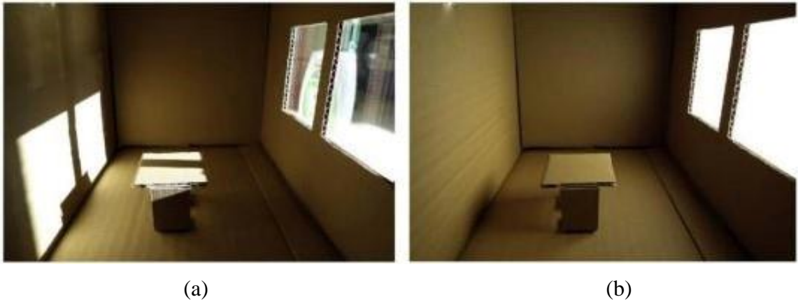
Şekil 15. Karton ev modeli kullanılarak gün ışığı yönetimi ile (a) aynasal çift cam (b) dağınık aerojel cam arasında karşılaştırma
