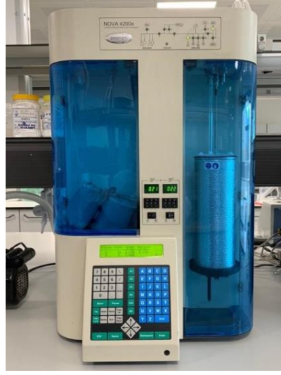
Şekil 58. BET analiz cihazı
