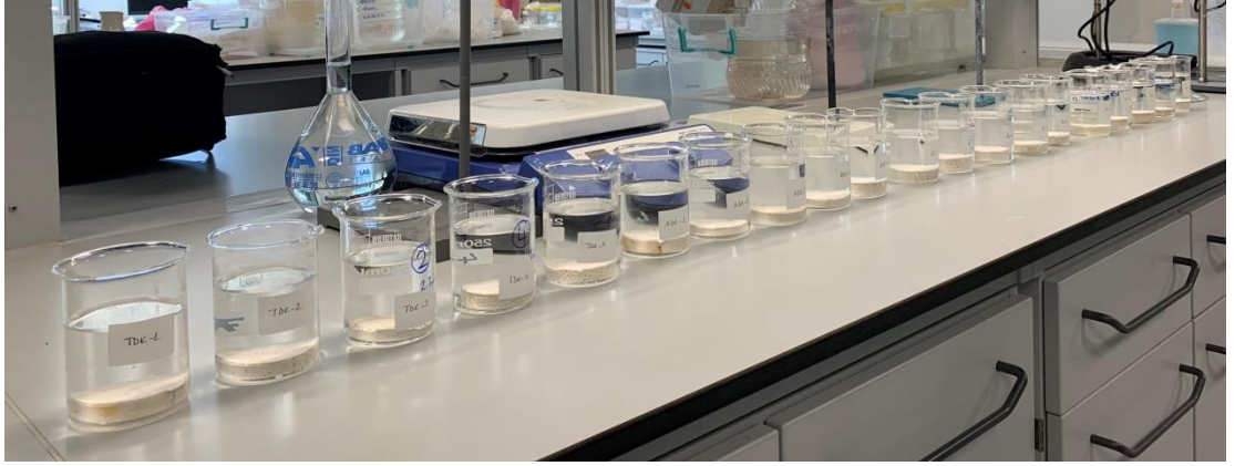
Şekil 53. Su emme oranı tayini için TDK, ADK, K ve R'den üretilen silika aerojel tozları ile hazırlanan deney numuneleri
