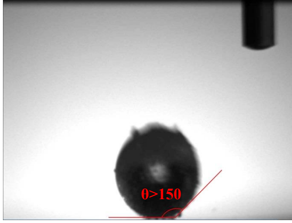
Şekil 89. TMCS ile yüzey modifikasyonu yapılmış olan süperhidrofobik silika aerogelin temas açısı ölçümü
