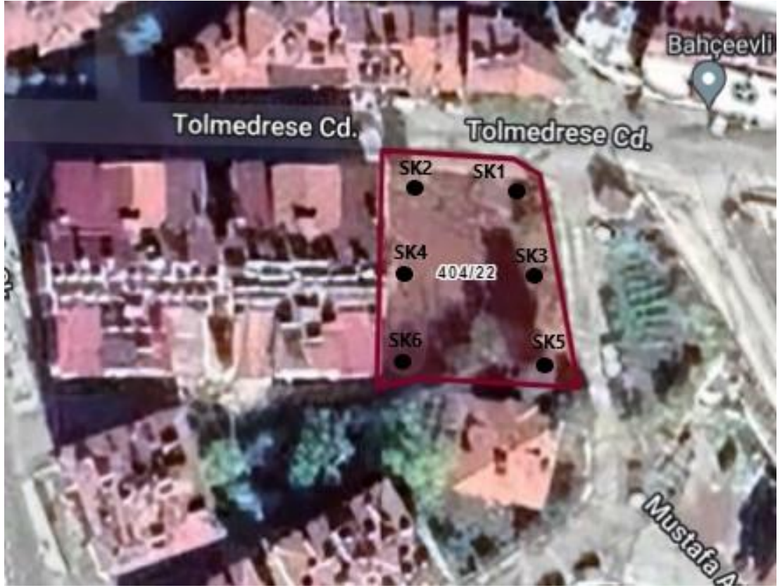
Şekil 106. Ermenek 404 ada 22 parselde yapılan sondajların uydu görüntüsü
