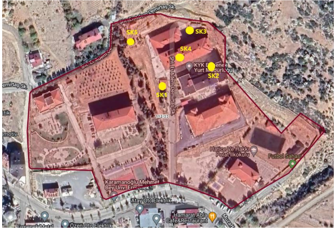
Şekil 9. Ermenek 112 ada 33 parselde yapılan sondajların uydu görüntüsü
