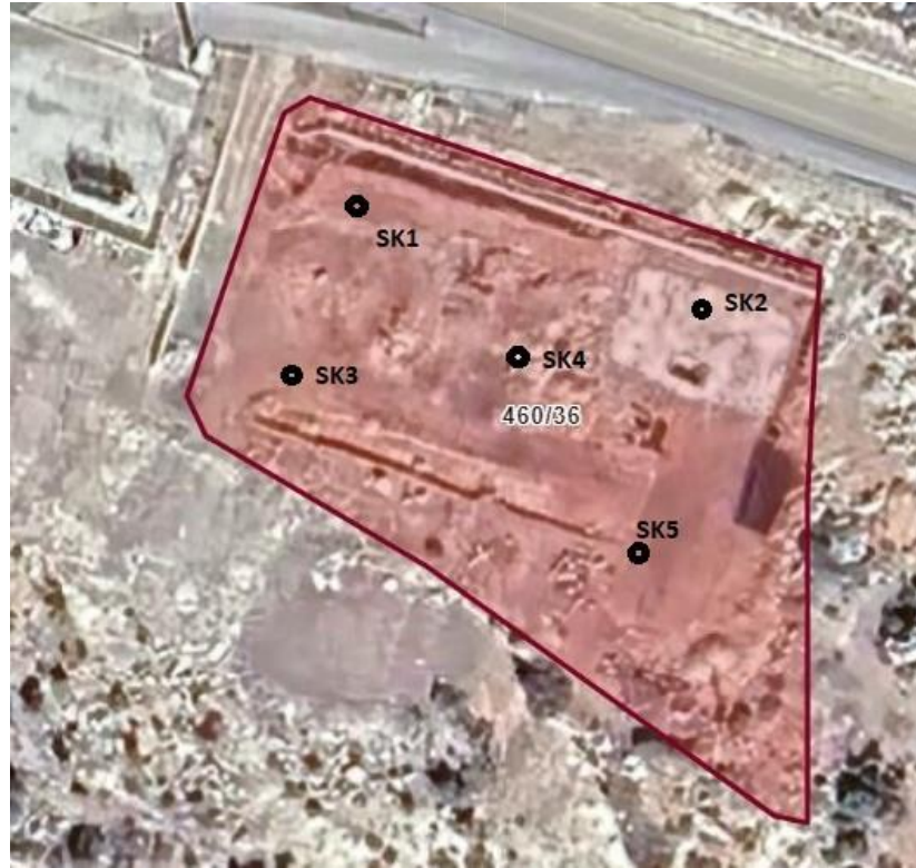
Şekil 40. Ermenek 460 ada 36 parselde yapılan sondajların uydu görüntüsü
