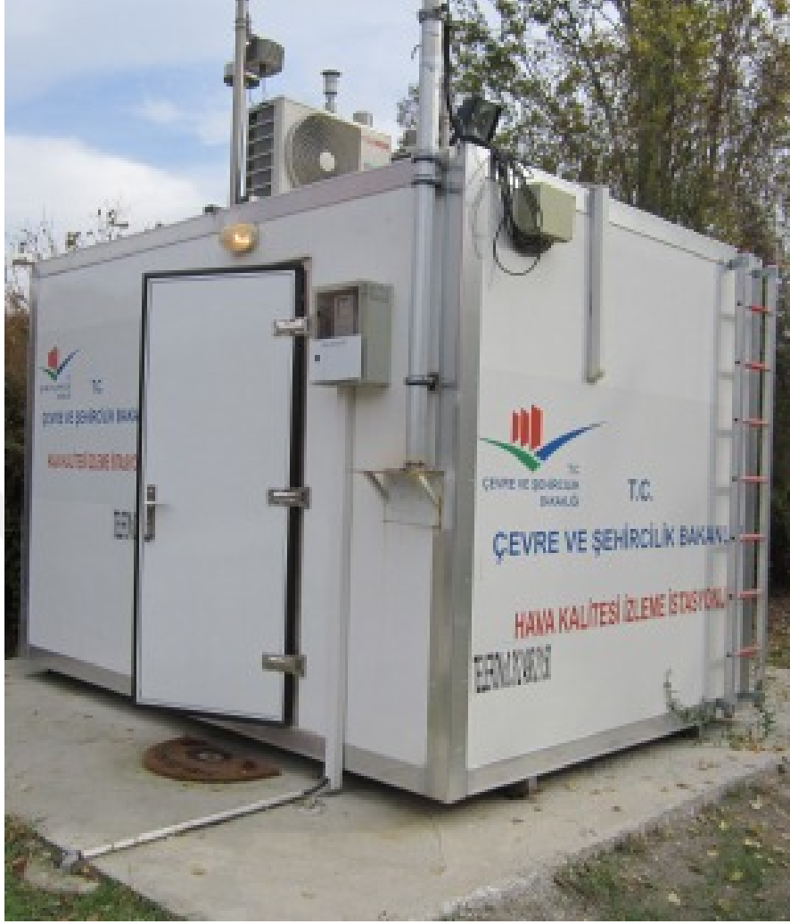
Şekil 4.3: Örnek hava kalitesi izleme istasyonu [59]
